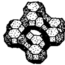
图5-17 A型沸石的晶体结构
