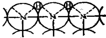
图 2-5 氢分子化学吸附在镍表面上形成 Ni_2H 吸附态的示意图
