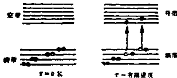
图5-42 在有限温度下半导体电子的能级跃迁
