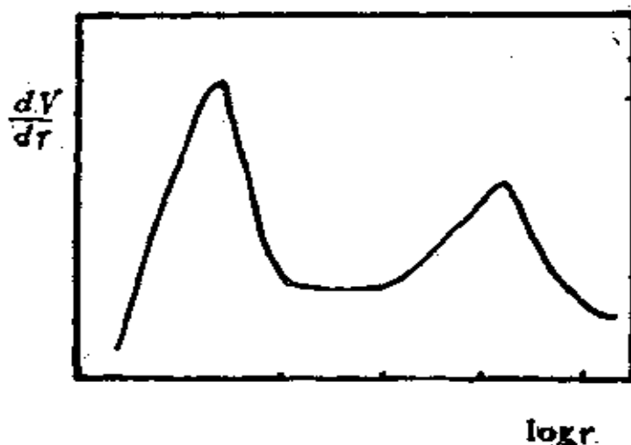
图4-8 多孔分布型催化剂的孔径分布
